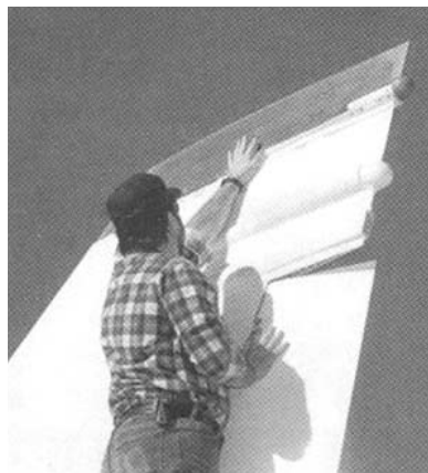
图 1.2 格鲁曼公司在 F/A-18 飞机上安装灵巧蒙皮天线
